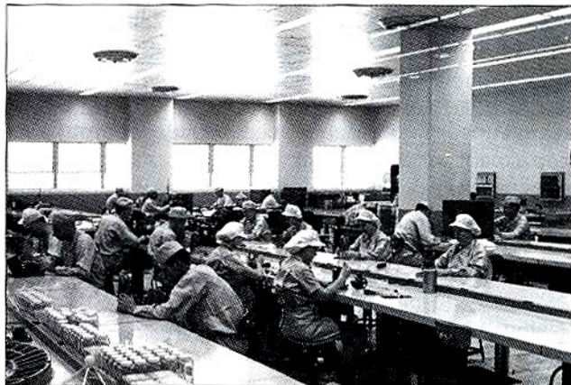
Une des premières salles propres aux Etats-Unis (1955). Montage de gyroscopes
