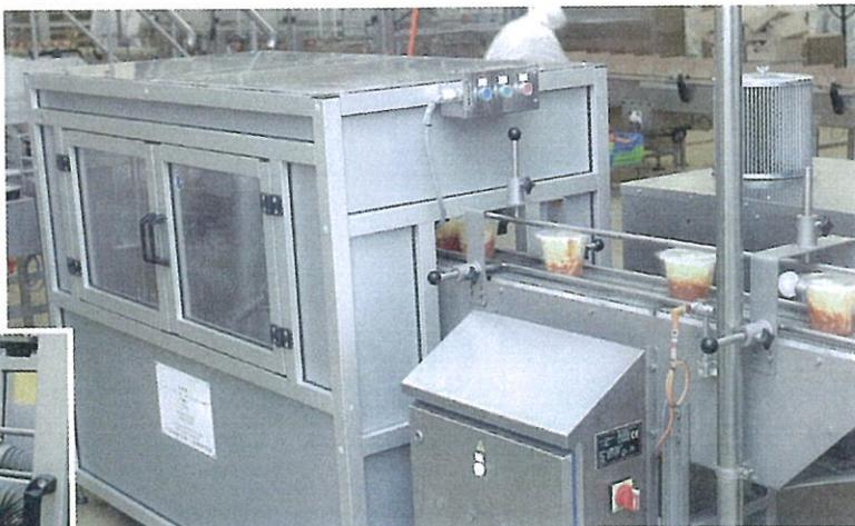
Le poste de séchage des barquettes réalisé par SEA Productique. Le convoyeur est intégré dans une cabine d'insonorisation formée d'un bâti alu et de panneaux en PVC. L'électronique de commande est regroupé dans une armoire.
